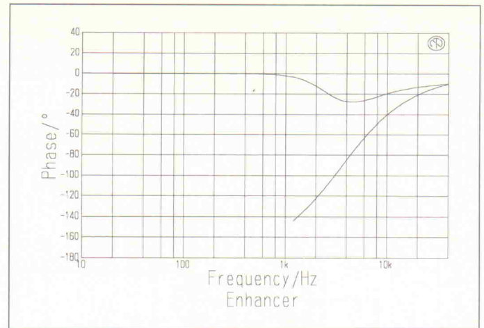
Bild 4. Phasengang eines Enhancers über alles (oben) und im Filterzweig (unten).
