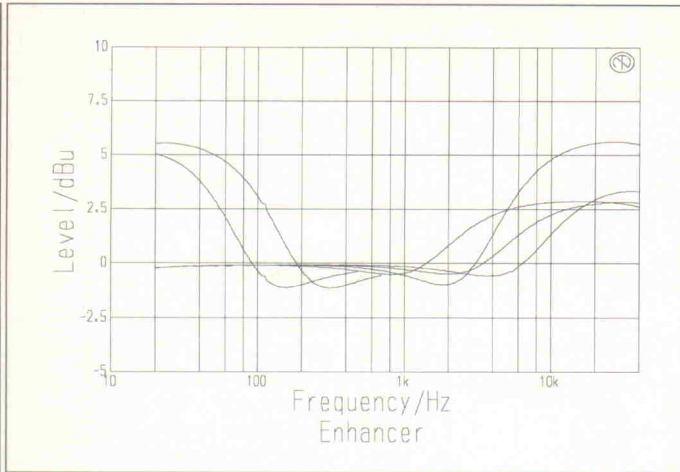
Bild 3. Pegelschriebe eines Enhancers in verschiedenen Einstellungen (rechts normal, links Baß-Enhancer).
